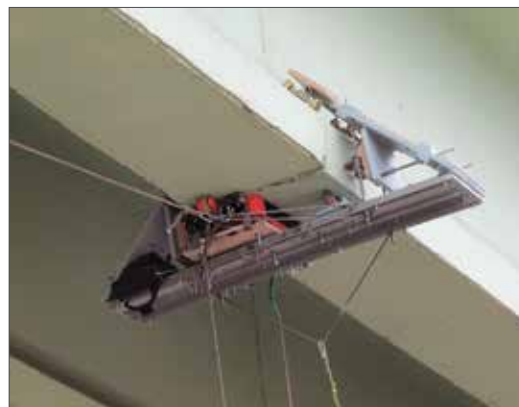
Рис. 8. Неразрушающий контроль преднапряженных балок пролетных строений МС при помощи магнитного дефектоскопа «Интрос»
